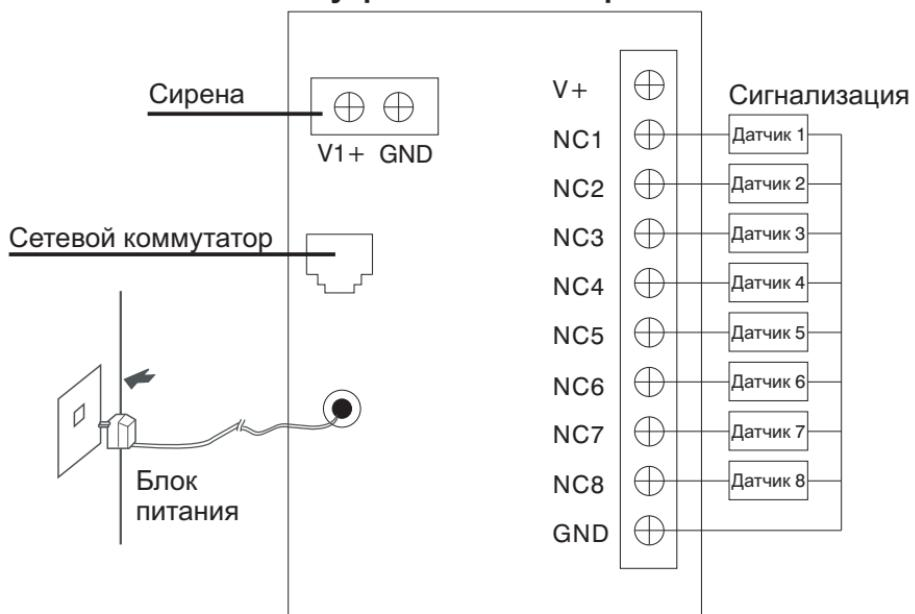
**⚠ Примечание:** все датчики сигнализации должны быть подключены в «нормально открытом» состоянии. Смотрите схему подключения ниже:
