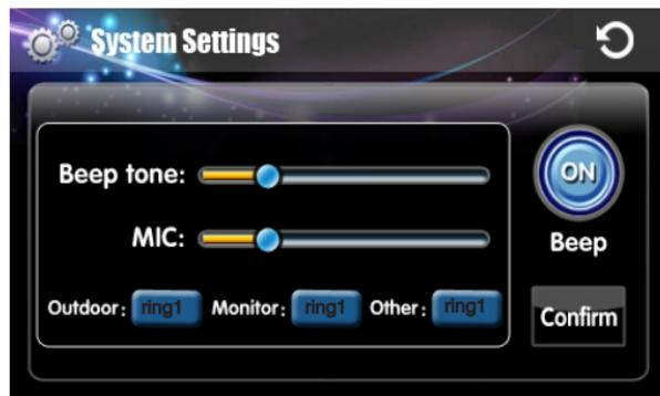
Нажмите на кнопку «Сигнал», чтобы включить или выключить звуковой тон при нажатии. Отрегулируйте ползунками уровень громкости и уровень чувствительности микрофона. Нажмайте на кнопки устройств и выберите одну из четырех мелодий для каждого из устройств. Нажав на кнопку воспроизведения, можно прослушать выбранную мелодию. Для сохранения выбранной мелодии, нажмите кнопку «Подтвердить».
