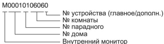
«D» — многоквартирная вызывная панель. «M» — внутренний монитор, «Н» — индивидуальная вызывная панель, «С» — пульт консьержа.
